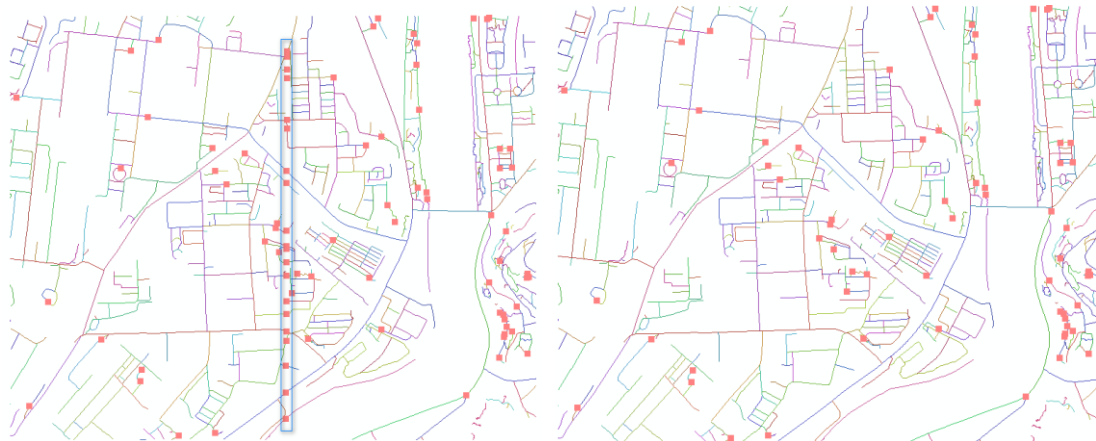
图4 左图是未接边的数据右图是移除不合理伪节点后的检查结果
